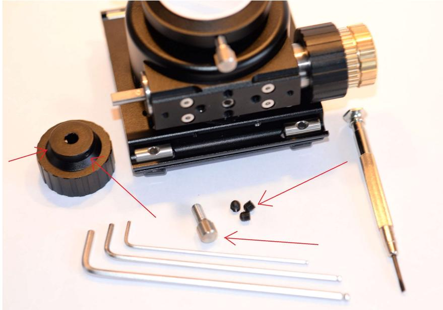
**Entfernen Sie die drei geschlitzten Madenschrauben; Rändelschraube entfernen;
