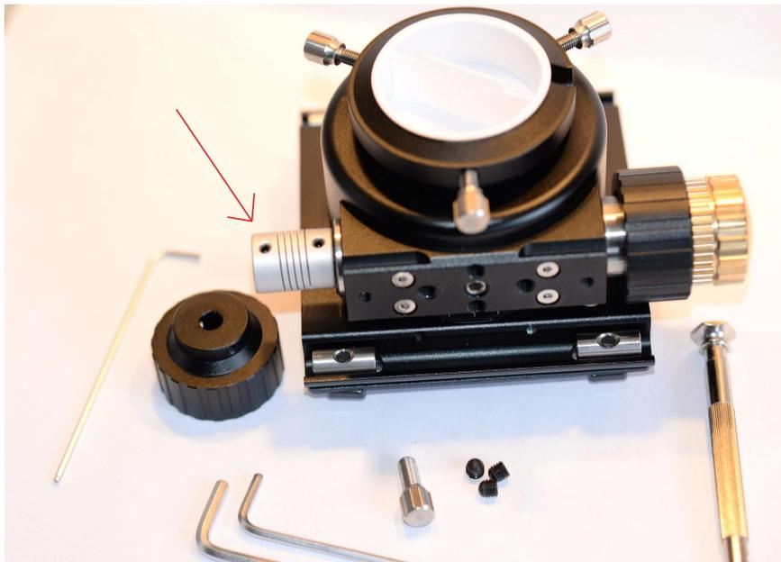
**Montieren Sie die flexible 5 zu 7mm Kupplung mit zwei Madenschrauben**
