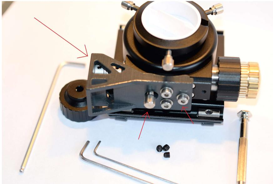
**Montieren Sie die Halterung an den Okularauszug mit den M6 Schrauben und Unterlegscheiben (nicht **anziehen**) inkl. der Rändelschraube (diese nicht anziehen ! )**
