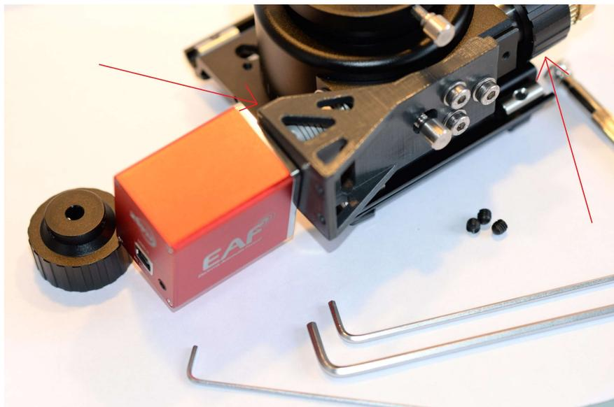
**Montieren Sie den Motor an die flexible Kupplung (zwei Madenschrauben 90° Position), verwenden Sie den rechten Fokussierknopf um den Motor zu drehen, bei Bedarf**
