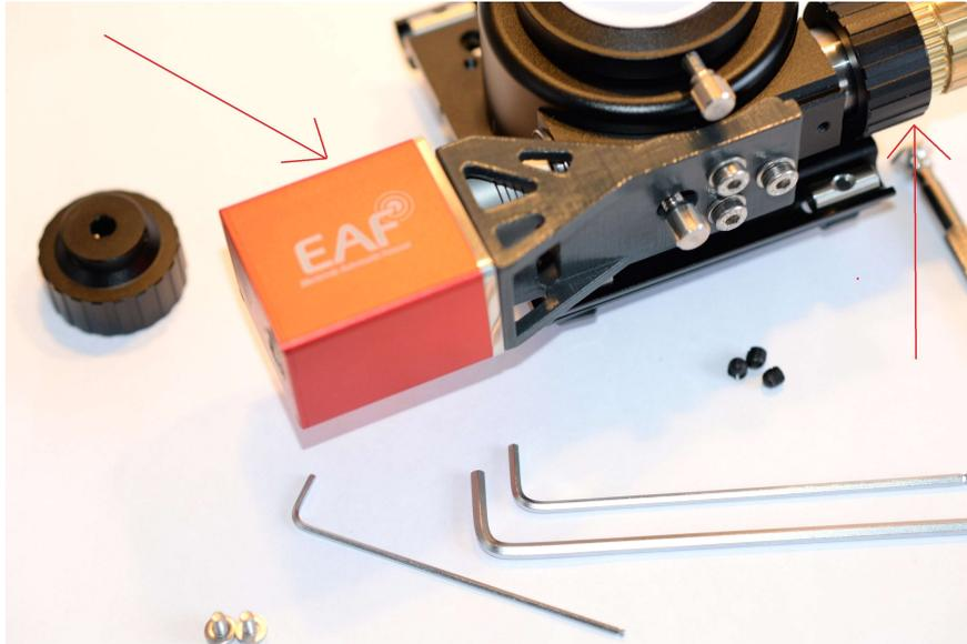
*Drehen Sie den Motor in die korrekte Position **durch Benutzen des Fokussierknopfes auf der rechten Seite***
