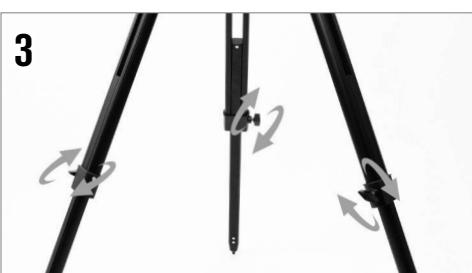
Den mittleren Teil jeder der drei Beinstreben ca. 15 bis 30 cm nach unten ausziehen. Die ausgezogenen Beine mit den drei Feststellschrauben unten an jedem Bein sichern.
