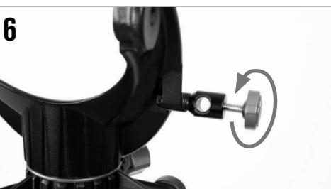
Desserrez la molette sur la tige-guide d'altitude, sur le côté de la monture à fourche, pour libérer le trou.
