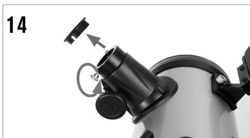
Allentare le viti sul focheeggiatore del telescopio e rimuovere il coperchio antipolvere.
