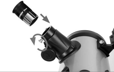
Para instalar el ocular, afloje los tornillos del enfoque. Introduzca el cañón plateado de la parte inferior del ocular en el enfoque y asegúrelo apretando los tornillos. Comience siempre usando el Ocular de baja potencia (25 mm) para ayudarle a localizar el objetivo que desee ver. Siempre puede cambiar al ocular de alta potencia (10 mm) más tarde.
