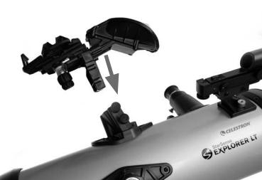
Para instalar el soporte de teléfono StarSense afloje los dos tornillos del soporte en la parte superior del telescopio y deslice el encaje de la parte inferior del conector en el soporte. Asegúrelo en posición apretando ambos tornillos.
