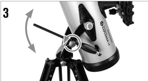
Um das Teleskop auf- und abwärts zu bewegen, halten Sie den Fokussierer des Teleskops mit einer Hand und lösen Sie den Knopf an der Zeitlupenführungsstange. Das Teleskop kann nun wie gewünscht nach oben oder unten bewegt werden. Wenn Sie sich Ihrem Ziel nahe sind, ziehen Sie den Knopf fest, um das Teleskop zu sichern.
