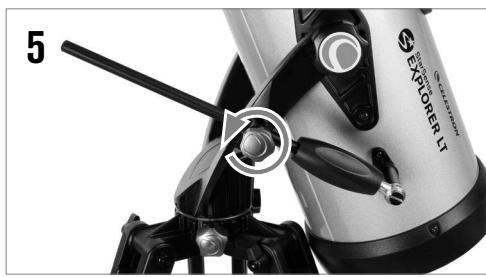
L'asta del movimento lento per l'altitudine ha un intervallo di movimento limitato di circa 15 gradi. Se si arriva al finecorsa e la manopola non può essere ulteriormente ruotata, è possibile ripristinarla allentando la manopola della guida dell'asta e ruotando la leva dell'asta del movimento lento in direzione opposta fino a quando non si torna a metà del percorso disponibile, quindi serrare nuovamente la manopola della guida dell'asta.
