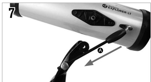
Faites glisser la tige d'altitude dans le guide de la tige A sur la monture et abaissez les axes d'altitude du tube du télescope dans les nacelles situées en haut de chaque bras de la fourche.
