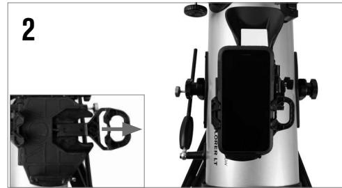
Ouvrez la glissière à ressort située sur le dessus du support de téléphone et installez le téléphone pour qu'il soit à niveau sur le rebord du bas du support de téléphone. Relâchez la glissière en douceur pour maintenir le téléphone en place.
