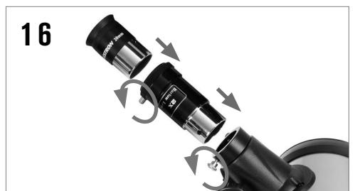
Per utilizzare la lente Barlow, rimuovere l'oculare dal focheeggiatore del telescopio, inserire la lente Barlow nel focheeggiatore e inserire l'oculare nella lente Barlow. Ciò consente di raddoppiare l'ingrandimento di qualsiasi oculare utilizzato.
