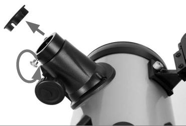
Lösen Sie die Stellschrauben am Fokussierer des Teleskops und entfernen Sie die Staubschutzkappe.
