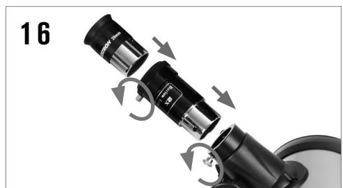
Pour utiliser la lentille de Barlow, retirez votre oculaire du système de mise au point du télescope, insérez la lentille de Barlow dans le système de mise au point et insérez votre oculaire dans la lentille de Barlow. Cela permettra de doubler le grossissement offert par l'oculaire que vous utilisez.
