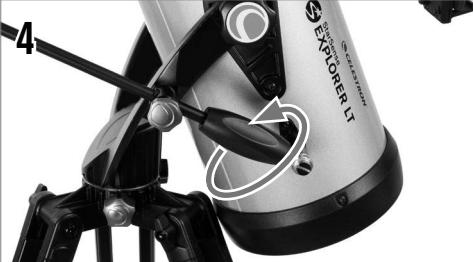
Vous pouvez régler l'orientation vers le haut et le bas finement à l'aide de la tige d'altitude à mouvement ralenti. Laissez la molette du guide de la tige serrée et faites pivoter la poignée noire sur la tige de mouvement ralenti. Cela vous permet d'orienter le télescope par petits incrément pour vous aider à centrer des objets ou à suivre des objets célestes dans le ciel nocturne.
