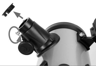
Afloje los tornillos del enfoque del telescopio y saque la tapa.
