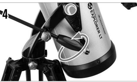
Per spostare il telescopio verso l'alto e verso il basso, tenere il focheggiatore del telescopio con una mano e allentare la manopola sulla guida dell'asta del movimento lento. Il telescopio può essere ora spostato verso l'alto e verso il basso a piacimento. Quando si è vicino all'oggetto, serrare la manopola per fissare il telescopio in posizione.
