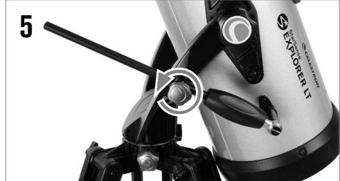
La tige de mouvement lent dispose d'une plage de mouvement limitée d'environ 15 degrés. Lorsque vous arrivez en bout de la course permise par la molette et qu'elle ne peut plus tourner, vous pouvez la réinitialiser en desserrant la molette du guide de la tige et en tournant la poignée de la tige de mouvement ralenti dans la direction opposée jusqu'au milieu de sa course. Resserrez ensuite la molette du guide de la tige.
