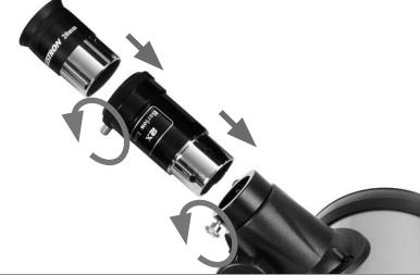
Para usar la lente Barlow, saque el ocular del enfoque del telescopio, introduzca la lente Barlow en el enfoque e introduzca su oocular en la lente Barlow. Doblará el aumento del oocular con el que la use.
