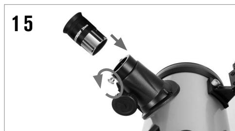
Per installare l'oculare, allentare le viti sul focheeggiatore. Inserire il barilotto color argento alla base dell'oculare nel focheeggiatore e fissare serrando le viti. Iniziare sempre con l'Oculare basso indice di ingrandimento (25 mm) per agevolare l'identificazione dell'oggetto che si desidera osservare. È sempre possibile passare in un secondo momento a un oculare con maggiore potenza (10 mm).
