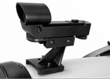
Ponga los dos agujeros en la base del localizador sobre los soportes estriados de forma que la base del localizador quede lisa sobre el tubo del telescopio. Asegúrese de que la ventana redonda del localizador esté orientada en dirección contraria al enfoque.
