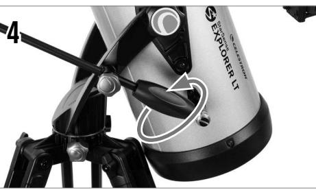
Para mover el telescopio arriba y abajo, aguante el enfoque del telescopio con una mano y afloje el mando de la guía del mango de movimiento lento. El telescopio podrá moverse arriba o abajo como desee. Cuando esté cerca de su objetivo, apriete el mando para asegurar el telescopio en posición.
