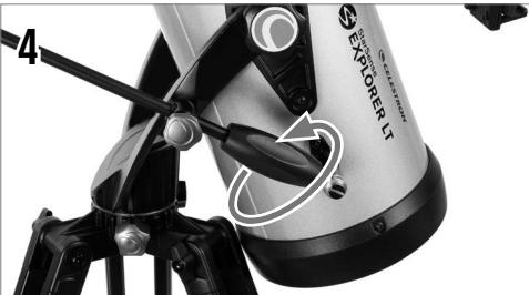
Die Feineinstellung in Auf- und Abwärtsrichtung kann mit der Zeitlupenstange für die Höhe erfolgen. Lassen Sie den Stabführungsknopf verriegelt und drehen Sie den schwarzen Griff an der Zeitlupenstange. Auf diese Weise können Sie das Teleskop in kleinen Schritten bewegen, um Objekte zu zentrieren oder Himmelsobjekten am Nachthimmel zu folgen.
