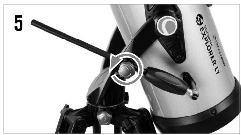
El mango de movimiento lento de altitud tiene un alcance de movimiento limitado, de aproximadamente 15 grados. Si llega al final del recorrido y el mando ya no puede girar más, puede restablecerlo aflojando el mando de guía del mango y girando el mango de movimiento lento en dirección opuesta hasta mitad de recorrido, y apretando de nuevo el mando de guía del mango.
