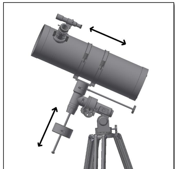
Figure 13. Équilibrer l'axe du télescope.
