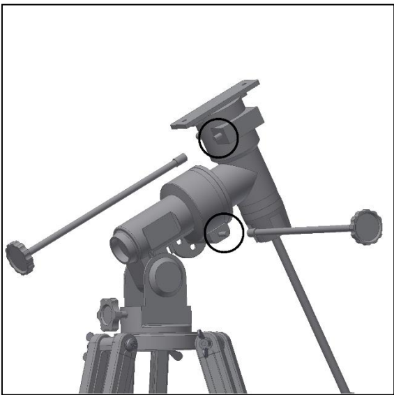
Figure 6. Placer les molettes.
