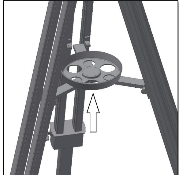
Figure 3. Placer la tablette porte-oculaire.
