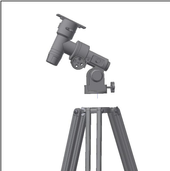
Figure 4. Placer la tête de la monture équatoriale.
