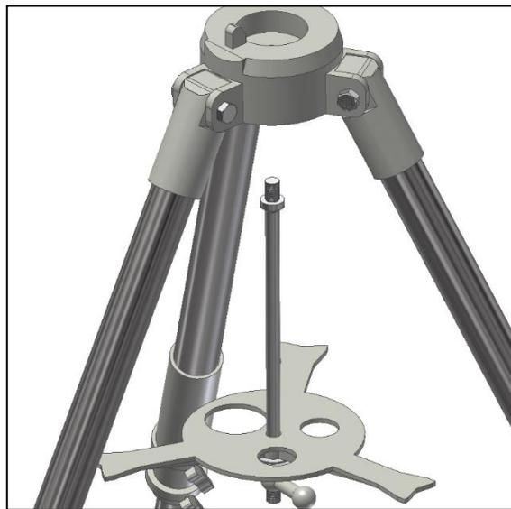
Fig. 6. Insérer l'ensemble pré-assemblé.
