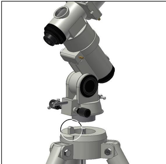
Fig. 13. Aligner la monture avec le montant du trépied.
