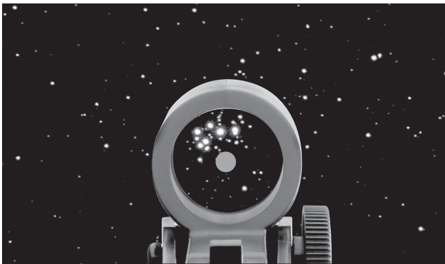
Figure 5. Le EZ Finder II superpose un petit point rouge sur le ciel, indiquant l'endroit où le télescope est pointé.
