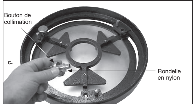
Figure 16. Représenté pour XX12g. a) Placez les trois ressorts sur les extrémités visibles des tiges filetées de la cellule du miroir. b) Placez la bague d'extrémité arrière sur la cellule du miroir de manière à ce que les tiges filetées la traverse et qu'elle repose sur les ressorts. c) Vissez les boutons de collimation, accompagnés de rondelles en nylon, sur les tiges filetées et à travers l'anneau d'extrémité arrière. Assurez-vous que les boutons sont engagés d'au moins trois tours complets sur les tiges.
