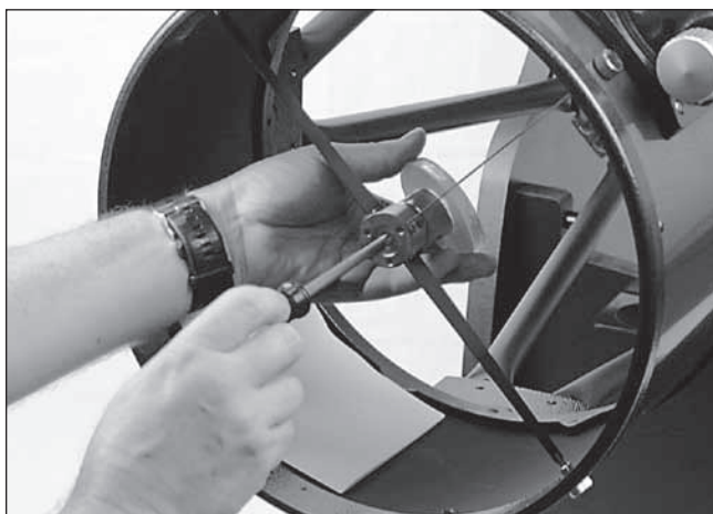
Figure 30. Pour centrer le miroir secondaire sous le porte-oculaire, maintenez le support du miroir en place d'une main tout en ajustant l'écrou central à l'aide d'un tournevis cruciforme. Ne touchez pas la surface du miroir !
