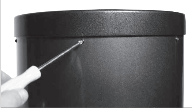
Figure 14. Pour retirer la bague d'extrémité arrière, dévissez les vis qui la fixent au tube.
