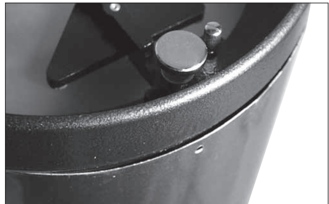
Figure 17. Localisez le renflement du tube qui empêche la bague d'extrémité de s'insérer totalement. Appuyez sur ce renflement jusqu'à ce que la cellule du miroir repose correctement sur le tube. Faites attention de ne pas vous pincer les doigts !
