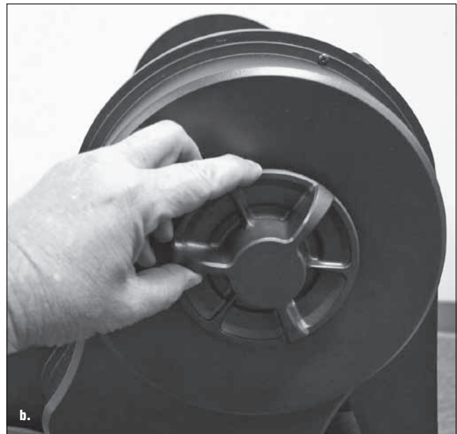
Figure 34. a) Les carters des moteurs/encodeurs d'altitude (Alt) et d'azimut (AZ) du Dobson XXg sont munis de grands boutons permettant de régler le degré de frottement du mouvement sur les deux axes. b) En tournant ces boutons, vous pouvez régler le frottement du mouvement sur les axes lorsque vous orientez le télescope à la main.
