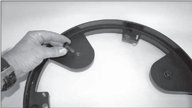
Figure 15. Placez les trois boulons cruciformes de montage des contrepoids (sur les modèles XX14g et XXg16 seulement) dans les orifices des plaques de support du contrepoids, comme le montre la figure. Serrez à l'aide d'une clé réglable ou d'une clé à molette de 16 mm.
