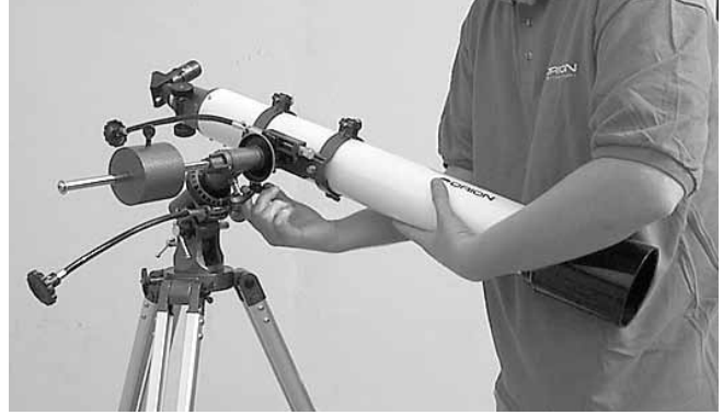
Figure 3c. Préparation de l'équilibrage du télescope sur l'axe de déclinaison en débloquant d'abord le bouton de blocage de la déclinaison.
