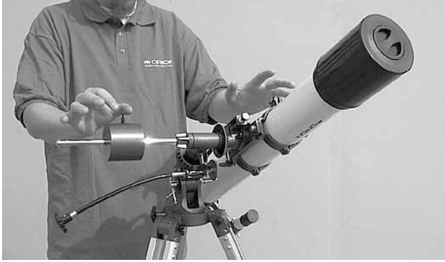
Figure 3b. Le télescope est maintenant équilibré sur l'axe RA. Autrement dit, lorsque les mains la lâchent, la barre de contrepois reste horizontale.
