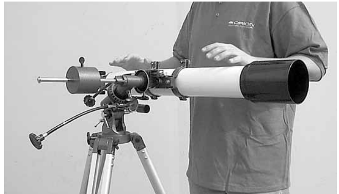
Figure 3e. Le télescope est maintenant équilibré sur l'axe de déclinaison, autrement dit, il reste horizontal lorsqu'on le relâche.
