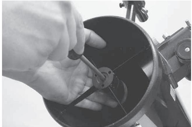
**Figure 15.** Pour centrer le miroir secondaire sous le porte-oculaire, maintenez le support du miroir en place d'une main tout en ajustant le boulon central à l'aide d'un tournevis cruciforme. Ne touchez surtout pas la surface du miroir !
