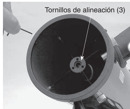
Figura 10. Ajuste la inclinación del espejo secundario, aflojando o apretando los tres tornillos de ajuste de alineación con una llave hexagonal de 2 mm.
