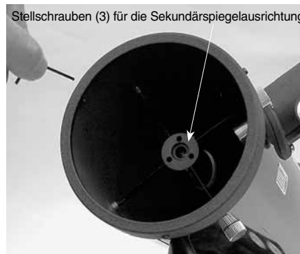
Abbildung 10. Stellen Sie die Neigung des Sekundärspiegels durch Lockern oder Festziehen der drei Stellschrauben für die Sekundärspiegelausrichtung mit einem Innensechskantschlüssel (2 mm) ein.
