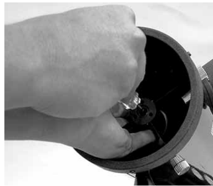
Abbildung 9. Zum Zentrieren des Sekundärspiegels unter dem Fokussierer halten Sie den Spiegelhalter mit den Fingern fest, während Sie die mittlere Schraube mit einem Kreuzschlitz-Schraubendreher festziehen. Berühren Sie keinesfalls die Spiegeloberfläche.
